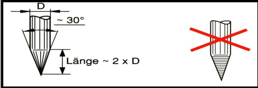
Die Elektrode wird in der Regel durch längsschleifen angespitzt. Schleifriefen sind in Sonderfällen durch polieren zu entfernen.
