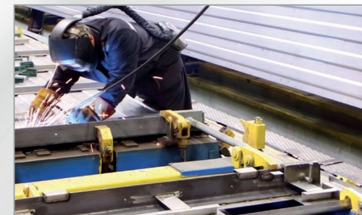
Schweisser im Einsatz, im Waggonbau mit Atemschutz-Filter
