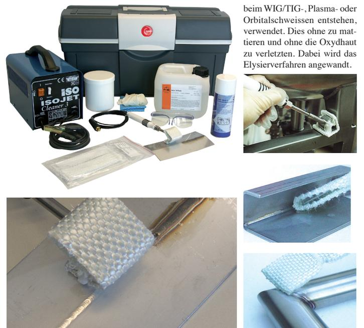
beim WIG/TIG-, Plasma- oder Orbitalsschweißen entstehen, verwendet. Dies ohne zu mattieren und ohne die Oxydhaut zu verletzen. Dabei wird das Elysiervverfahren angewandt.
