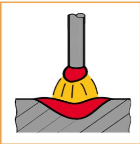
im Langlichtbogen werden mit hohen Leistungen grössere Wanddicken unter Kohlendioxid ( $\text{CO}_2$ ) MAG geschweisst. Der Werkstoffübergang ist grobtropfig und spritzerbehaftet.
