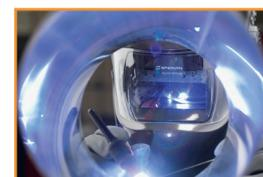
**WIG-Schweißen von Nickel:** Zulegieren von Titan im Schweißzusatz notwendig (porenmindernd), Wasserstoffzusatz verringert die Viskosität des Schweißbades, verbessert das Ausgasen und wirkt porenmindernd.
