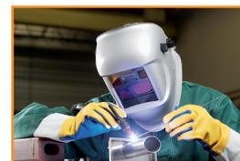
**WIG-Schweißen von sauerstofffreiem Kupfer:** Beim Schweißen dünner Bleche (bis ca. 3.0 mm) ist die Wurzelbildung am besten wenn in leichter Schräglage geschweisst wird.
