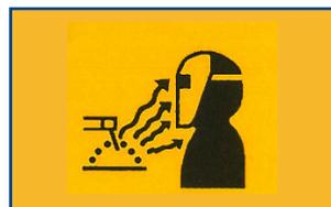
Gesicht und Augen sind vor abspringenden Schlackenteilen sowie den Folgenden der nahtbearbeitung zu schützen.
