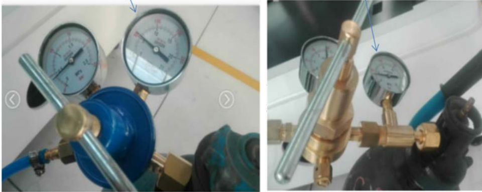
Abbildung 6-4: Komponente des Gaskanals (i)
