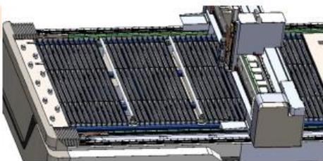
Aufgabenbeschreibung: Entfernen Sie die staubdichte Abdeckung der X-Achse und die Orgelabdeckung der Y-Achse. X-, Y-Achsen-Zahnstange, Zahnrad und Linearführungsschiene mit Reinigungstuch reinigen; Zahnstange nach der Reinigung schmieren
